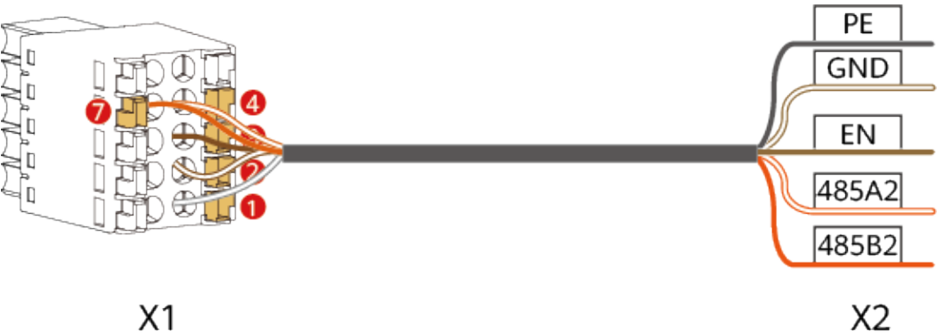
Figura 6-2 Cavo di segnale (acquistato dal fornitore, tipo 1) tra la batteria e l'inverter
